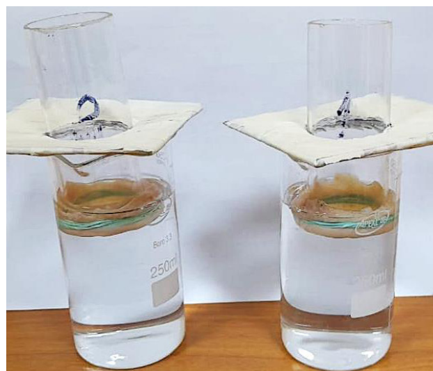
Рисунок 5. Прибор для определения биологической доступности ботулотоксина типа А методом равновесного диализа по Кривчинскому
