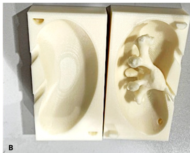
Рисунок 1. Напечатанные формы для заливки тела металлической пластиной на медиальной стенке для фиксации ребер и фрагмента подвздошной кости (А) и для заливки почки растворимой чашечно-лоханочной системы почки (В)
