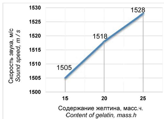
**Рисунок 1.** Зависимость скорости звука от содержания желатина в композиции
