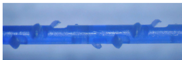
Рисунок 8. Фотография поверхности хирургической нити Alcadinone Figure 8. Surface image of the Alcadinone surgical suture
