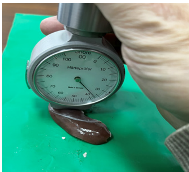
Рисунок 3. Оценка твёрдости паренхимы нативной почки барана (по Shore) с использованием дюрометра
