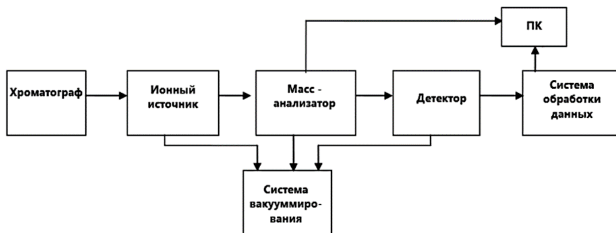
Рисунок 2. Схема основных узлов хромато-масс-спектрометра. Источник: Хроматограф.ру https://chromatograf.ru/2022/10/04/hromato-mass-spektrometry-princip-dejstviya/
